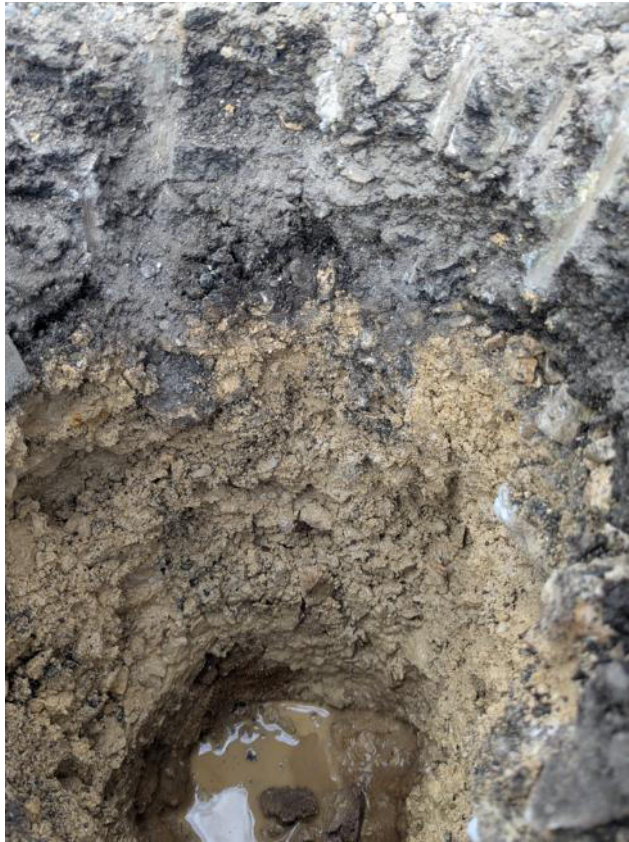
Abb. 3: Profilaufnahme SG 17 mit Schichtwasser auf Baugrund
