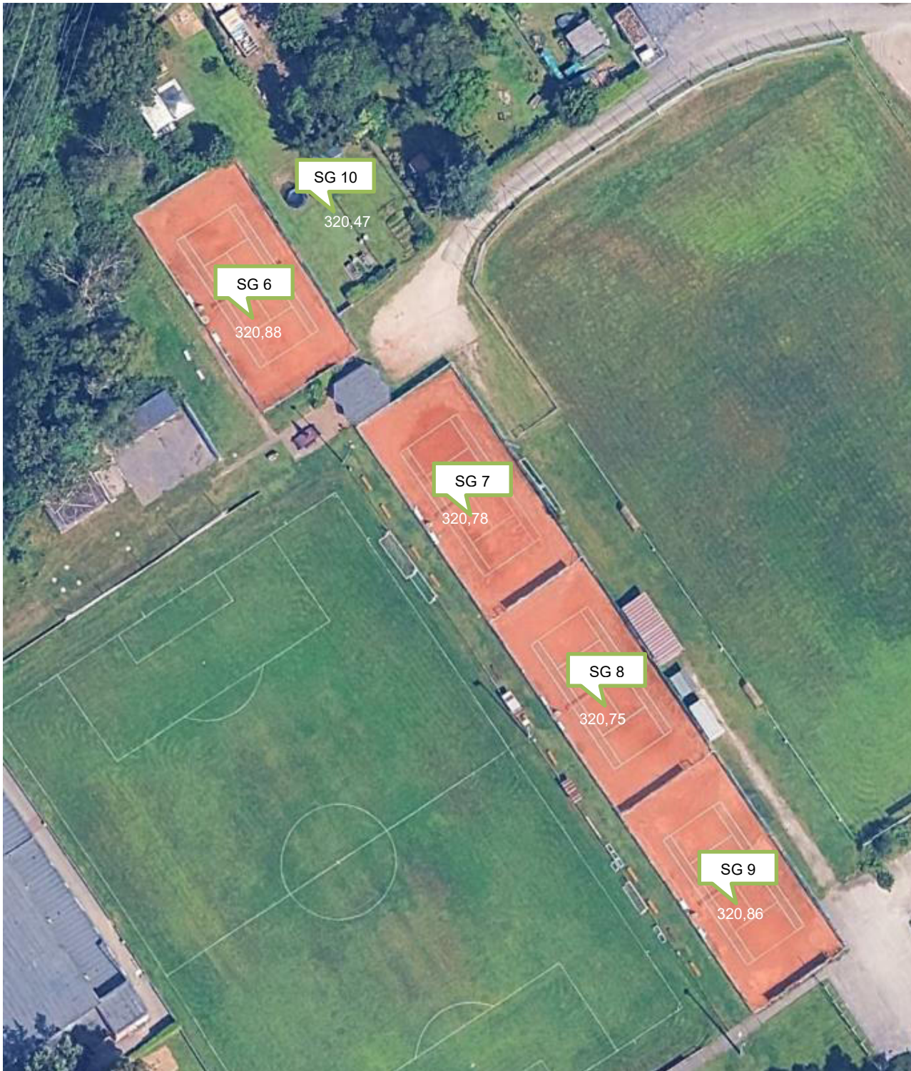
Abb. 1: Lageplan (unmaßstäblich) mit Prüfpunkten und Höhenangaben
