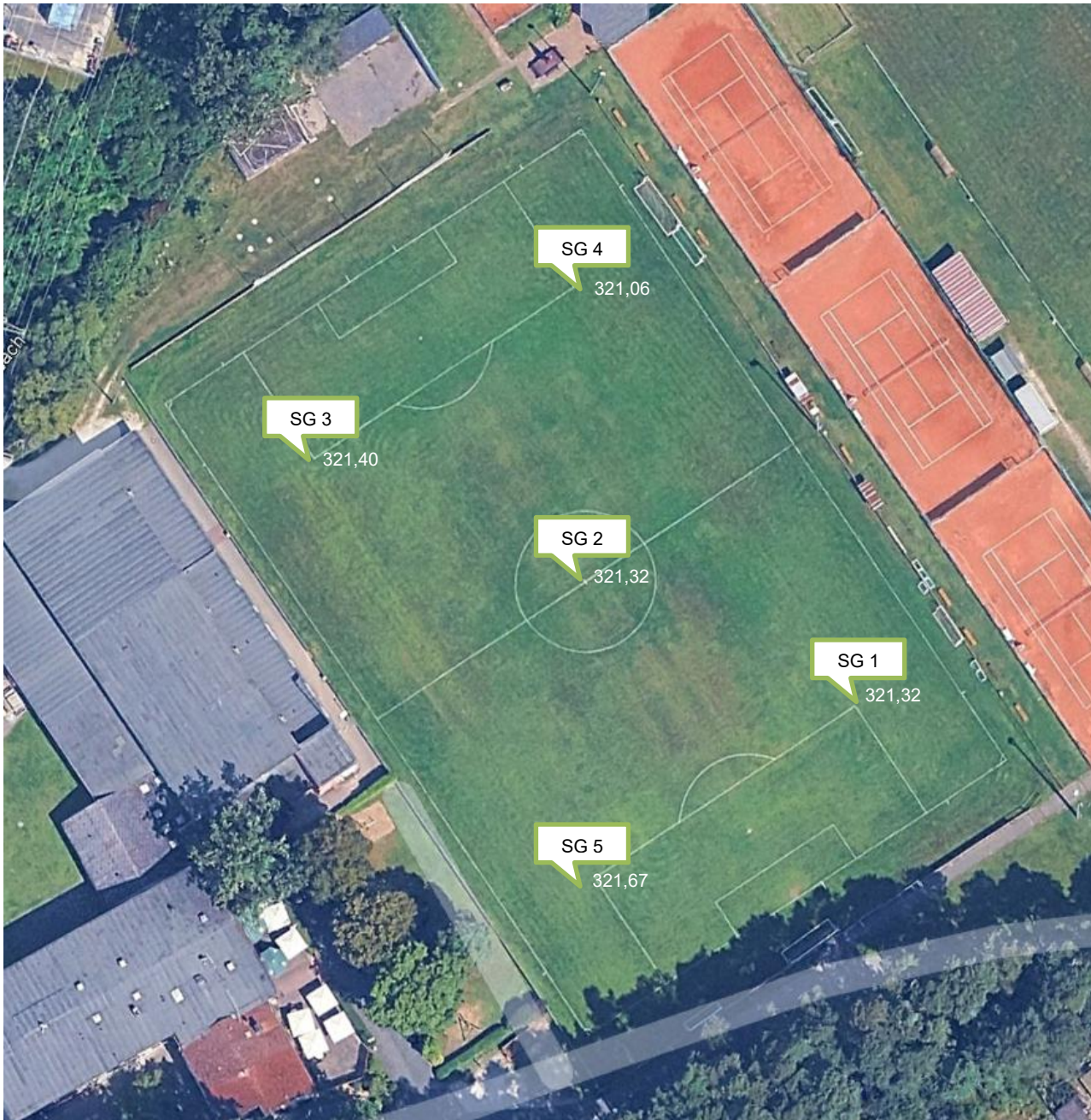
Abb. 1: Lageplan (unmaßstäblich) mit Prüfpunkten mit Höhenangaben (NN, interpoliert)
